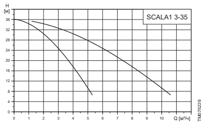
Расходно-напорная характеристика сдвоенной насосной установки SCALA1 3-35
