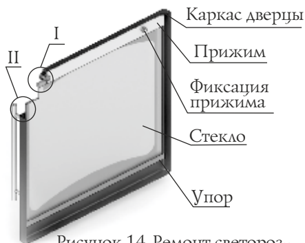
Рисунок 14. Ремонт светопрозрачного экрана дверцы модели «Витра»
